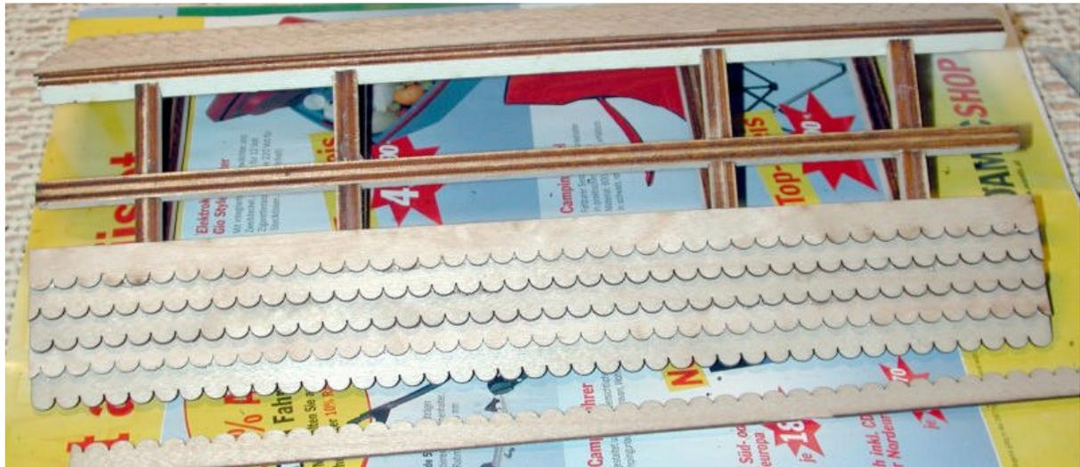
Die Dachschindeln sind in Wirklichkeit jeweils eine komplette Leiste und werden wie abgebildet abwechselnd (volle Schindel, halbe Schindel) aufgeklebt.
