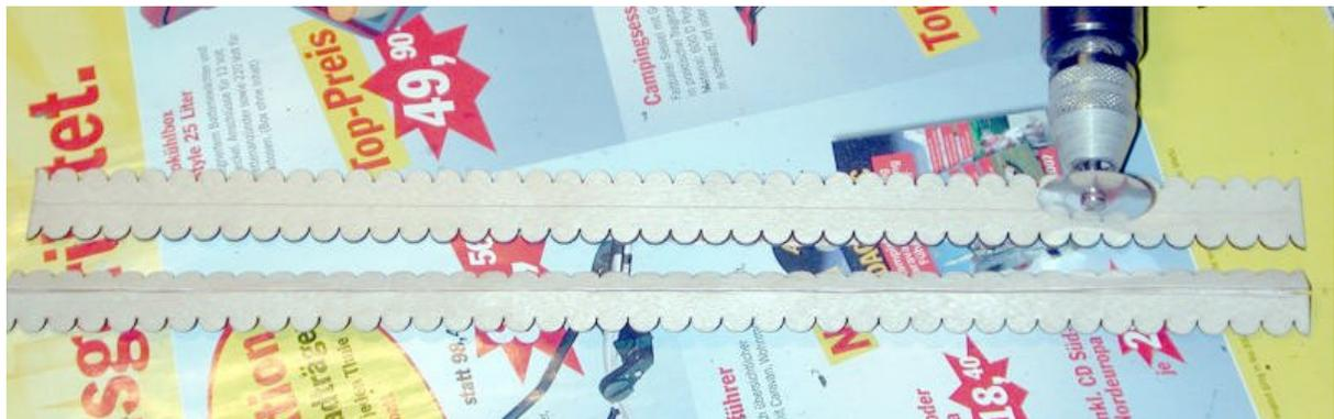
Den Abschluss bildet der „Dachfirst“. Dieser wird entlang der Gravur eingeritzt und dann scharfkantig im Dachwinkel gebogen.
