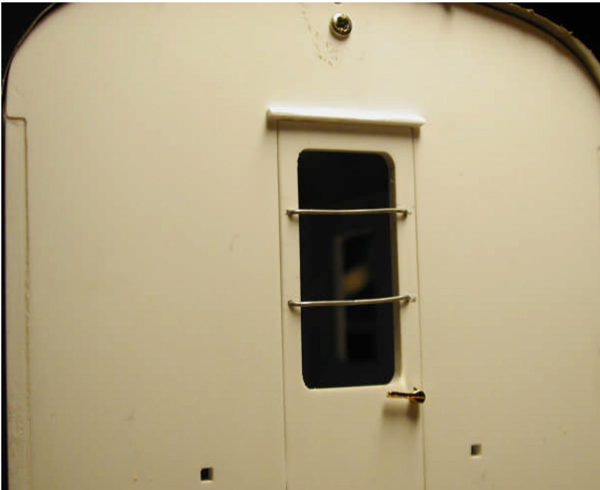
und werde aus 1mm Draht „vergittert“.
