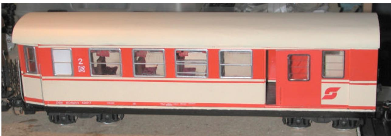
Die Fensterrahmen sind aus 1mm Polystyrol gefräst (liegen dem Teilesatz nicht bei!).
